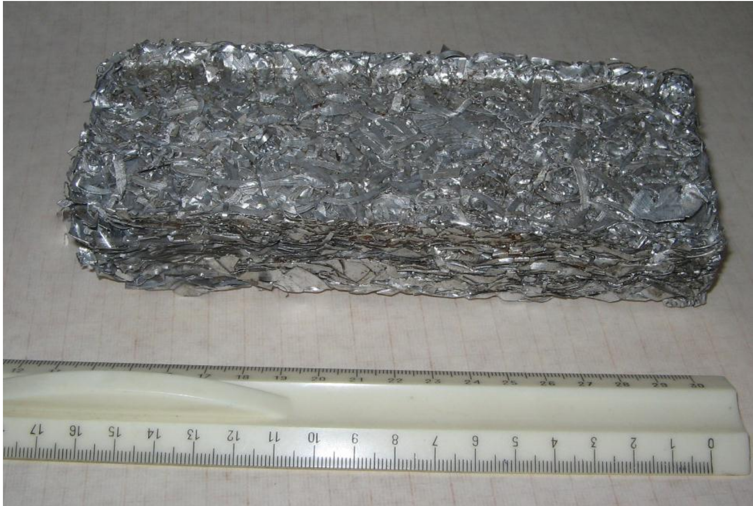
Фотография брикета из стружки алюминиевого сплава. Размер брикета: 175 \times 66 \times 28 мм; плотность 1,0 \text{ г/см}^3 (пористость 60%); масса 340 г.
