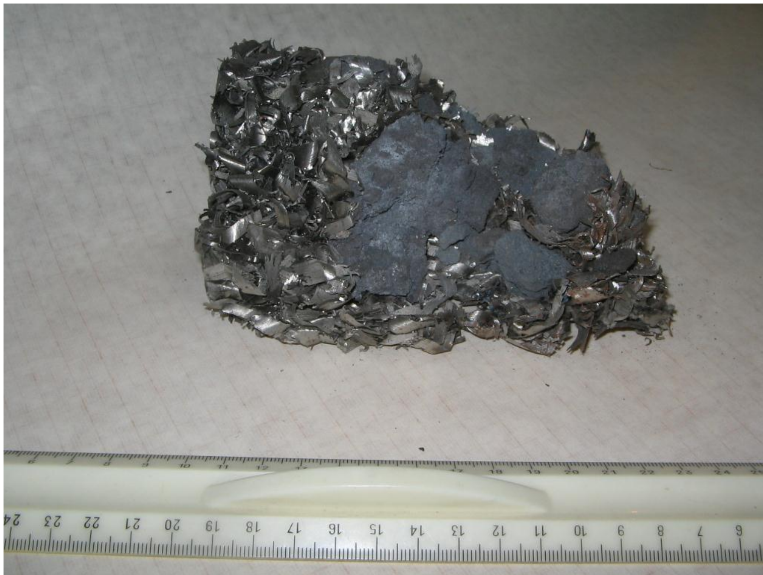
Фотография фрагмента композитного брикета из стружки стали Ст. 3 с добавкой кусков материала с малой электропроводностью (горной породы). Размер брикета: 200х60х60 мм; плотность 1,4 г/см 3 ; масса 1 кг (400 г стружки и 600 г породы).
