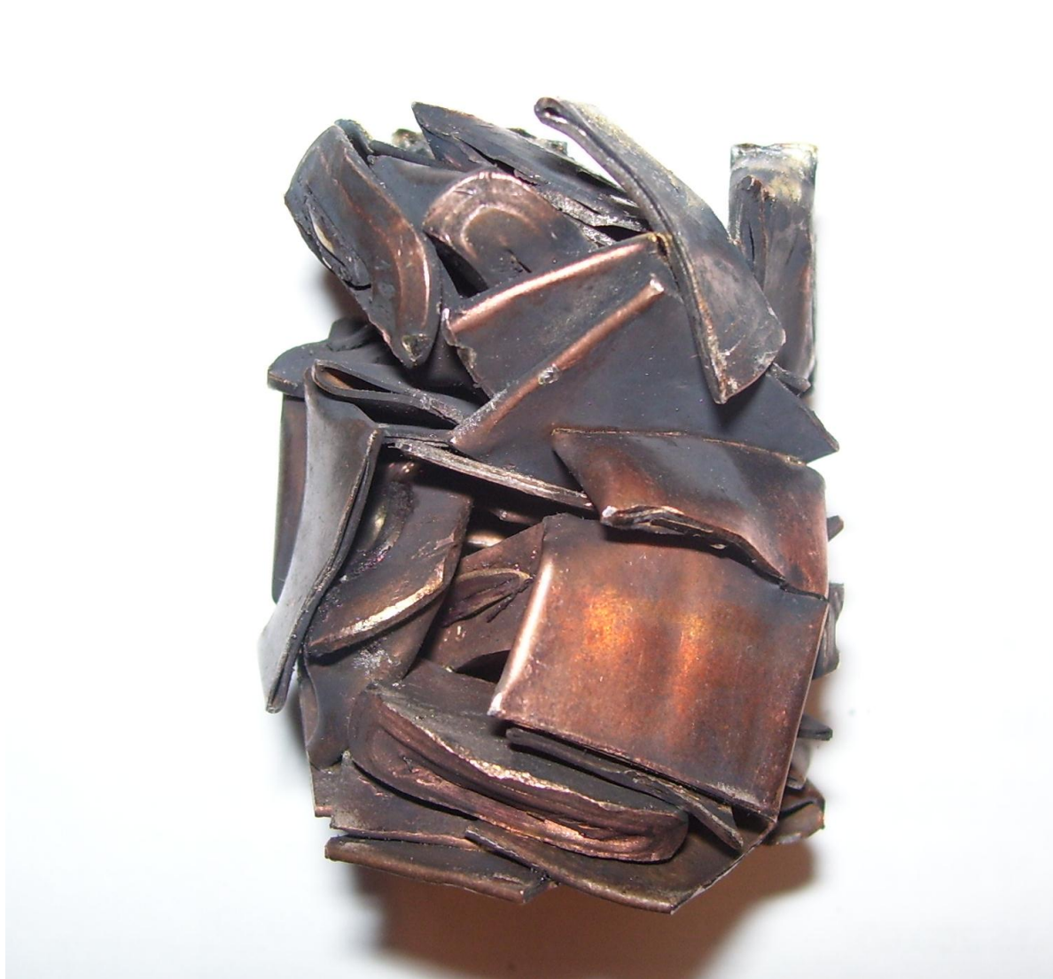
Фотография брикета из измельченного лома автоматных гильз, куски (1 – 4)х10х15 мм. Размер: диаметр 35 мм, высота 50 мм; масса 98 г, плотность 2,0 г/см 3 .
