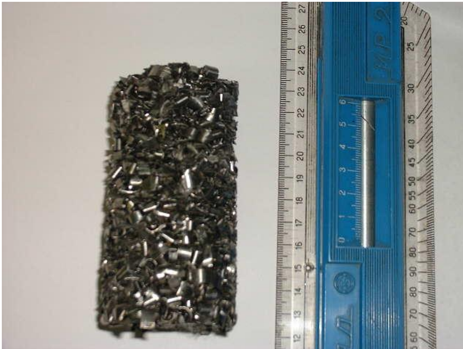
Брикет из стружки нержавеющей (высоколегированной) стали. Размер: диаметр 53 мм, высота 100 мм; плотность 1,5 г/см 3 (пористость 80 %); масса 340 г.
